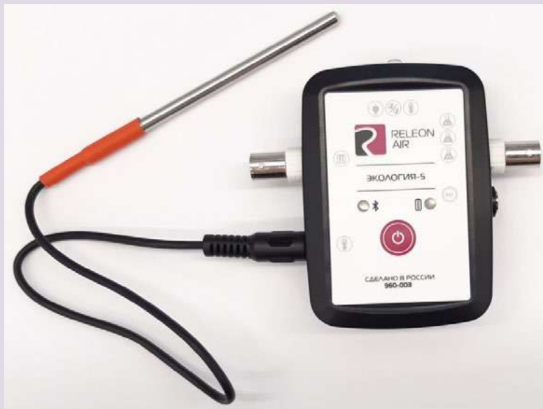
Рис. 6. Датчик температуры растворов
